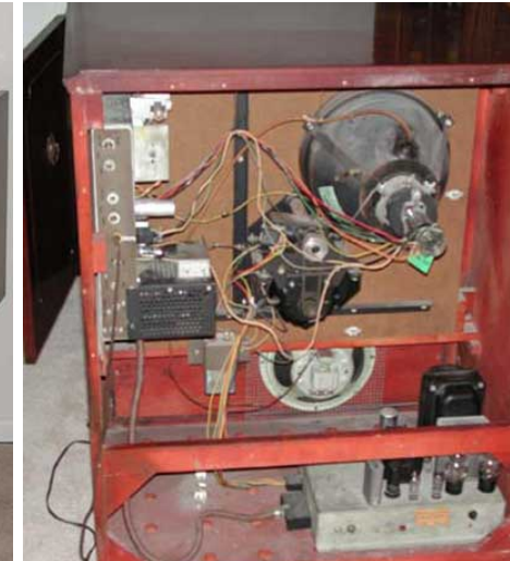
CBS-Columbia 12CC2, sur l'image montrant l'intérieur de dos, on voit l'arrière du tube cathodique et l'axe de rotation du disque.
