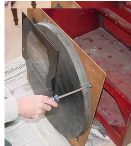
Démontage de la face avant d'un convertisseur Colortone de 1951 très similaire à celui utilisé dans les récepteurs CBS 12CC2. Il était vendu avec les composants électroniques nécessaires pour décrypter le signal CBS. On voit le disque RGB à 6 secteurs et la zone de l'écran. La taille du disque explique la taille du meuble.
